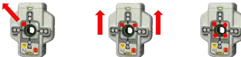
**Line Scan** - Pour accélérer le paramétrage des jours suivants, l'option Line Scan assure la prise en charge automatique des mouvements du faisceau laser dans les limites droite et gauche.
