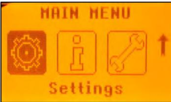
**Info** - Les informations sur le DG/RC (version logicielle, ID, etc.) ou la durée de fonctionnement du DG s'affichent.
